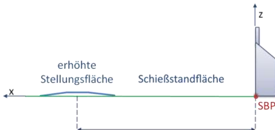
Abbildung 7 Skizze zum Bezugssystem im Schießstandtyp D Darstellung in der Schießstandmittelebene Schießrichtung von links nach rechts
