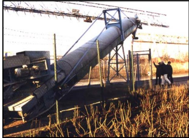
*Geschlossenes Förderband für den Transport stark staubender Güter aus einer Siloanlage*
