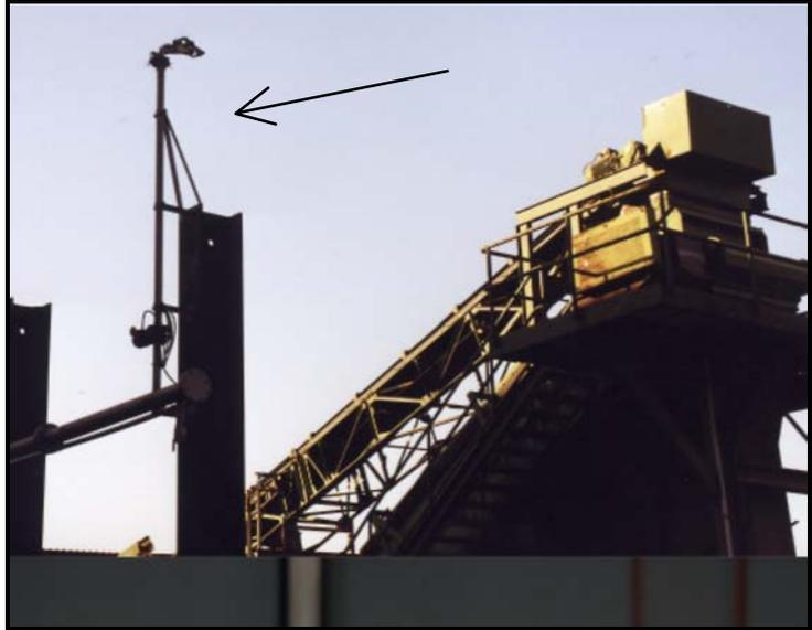
Oberirdisch verlegte Ringleitung mit fest installiertem Kreisregner in einer Bauschutttaufbereitungsanlage
